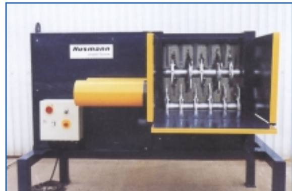
Kombination der Funktionen Pappen-Zerreißer und Hülse reißer
