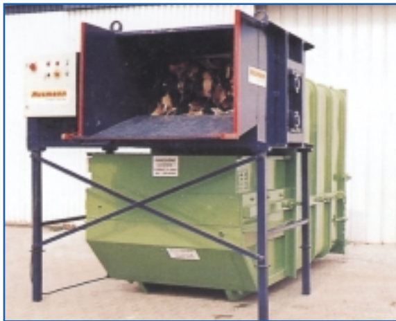
PZ 1400 kombiniert mit Selbstpressendem Behälter
