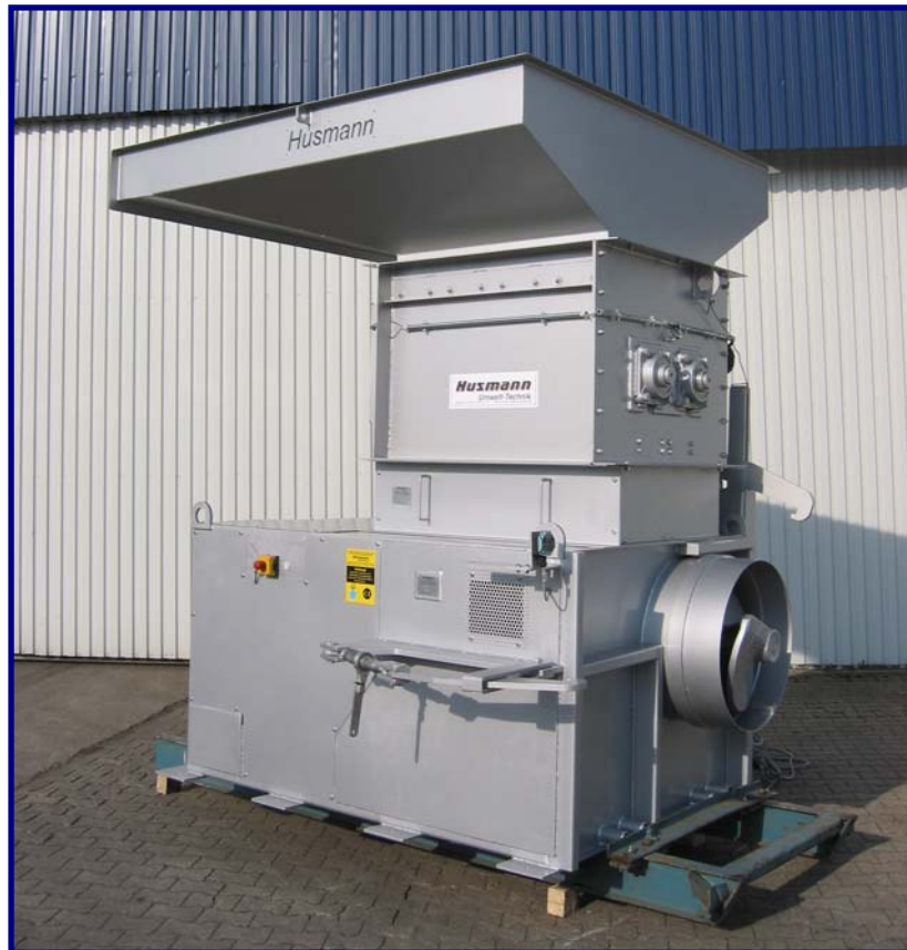
Schneckenpresse mit aufgesetztem HFP 75
